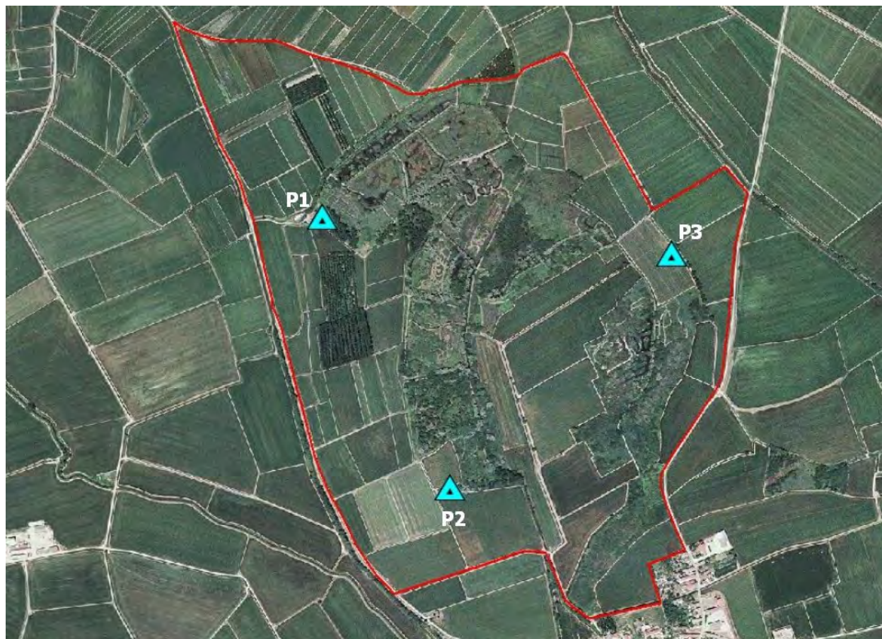
Figura 2.3 – Posizionamento dei piezometri all'interno del SIC Garzaia di Celpenchio.
